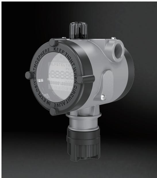
GTQ-ESD100/GTQ-ESD200/ESD100/ESD200系列点型气体探测器用于检测各种潜在的危险气体，根据气体的不同特性，使用不同的检测原理，包括电化学式，催化燃烧式。
