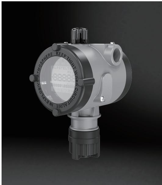
GT-ESD200IR/ESD200IR系列点型气体探测器采用英国的红外传感器，检测环境中可燃气体(%LEL)或有毒气体CO<sub>2</sub>(%V/V)的浓度。GT-ESD200IR/ESD200IR系列点型气体探测器使用双光路型式，具有更好的抗干扰能力，属于防爆设备，可安装在危险区域之1区和2区。
