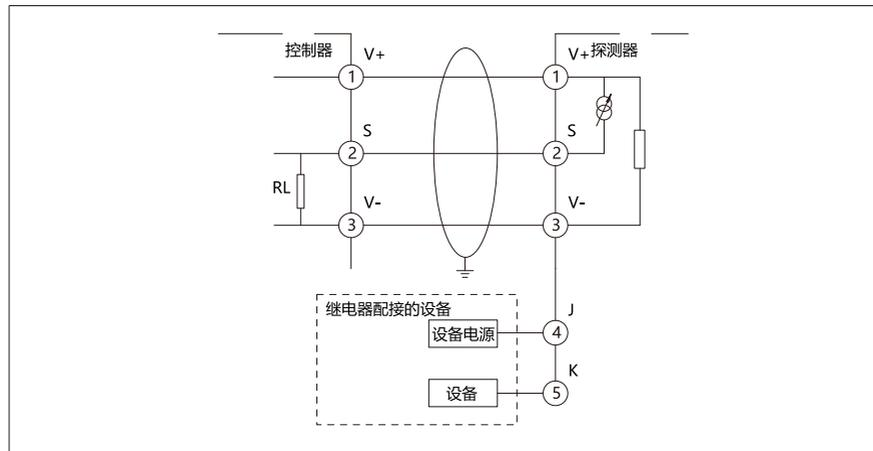
图 5-5-4 探测器与控制器的接线
